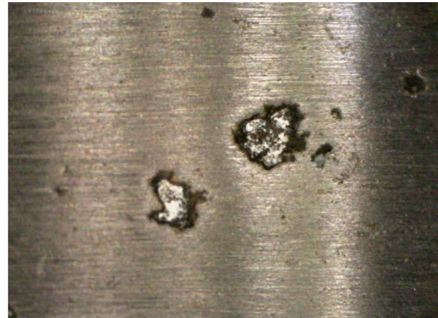
Abb. 2: Lochkorrosion – vernickelte Messingteile. Foto: I. Boerger
