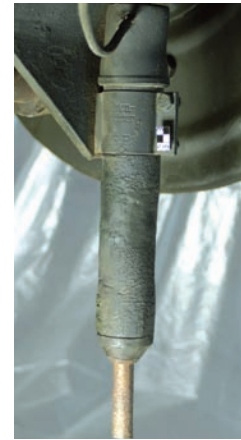
Abb. 18 Reifenwächter nach Konsolidierender Ergänzung offener Stellen und Konservierung des Gummimaterials
